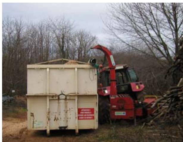
Fig. 8 – Estilhaçador móvel.
