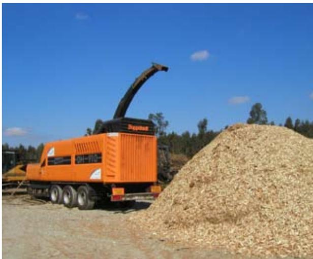
Fig. 9 – Estilhaçadora de grandes dimensões em parque de pré-tratamento.
